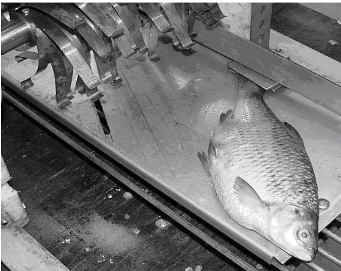
Rys. 12. Przeciąganie ryby uchwytem usytuowanym poza strefa działania freza (opracowanie własne)
