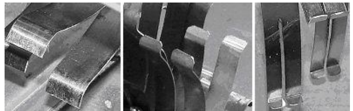
Rys. 13. Krawędzie robocze freza: agresywne szerokie (z lewej), łagodne wąskie (w środku), łagodne wąskie z rozcięciem (z prawej) (opracowanie własne)
